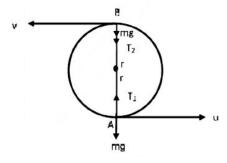
$$T_{max.} - T_{min} = 6mg$$
